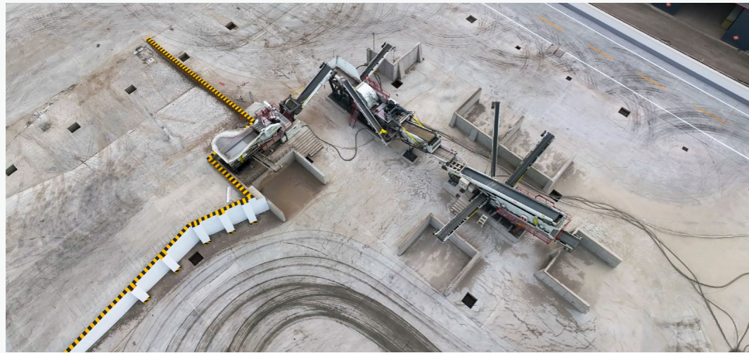
框架式移动破碎筛分生产线
