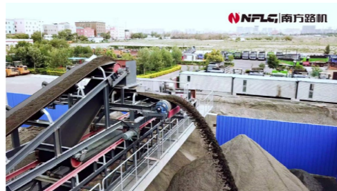
“LBPS 沥青混凝土回收料筛分设备+RAP 骨料再生”设备
