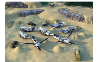
拆迁垃圾移动式处理线
