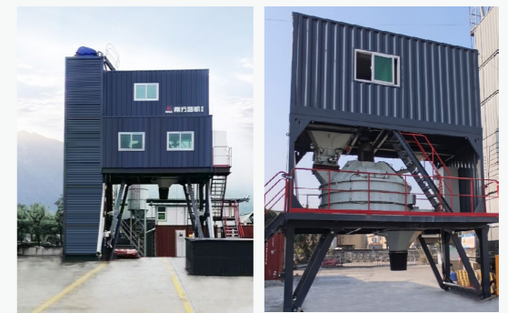
UHPC 专用搅拌设备
